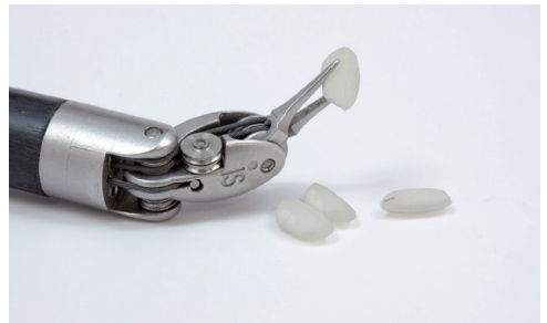
腹腔鏡よりも自由度の高い鉗子は、組織をつまむ・切る・縫合するなど、医師の手の動きに連動して正確に細かく動きます。
